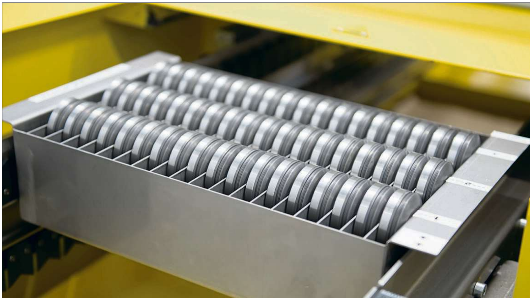
In Reih und Glied: Matrizen-Rohlinge warten bei der Pass Stanztechnik AG auf die automatisierte Weiterverarbeitung.
