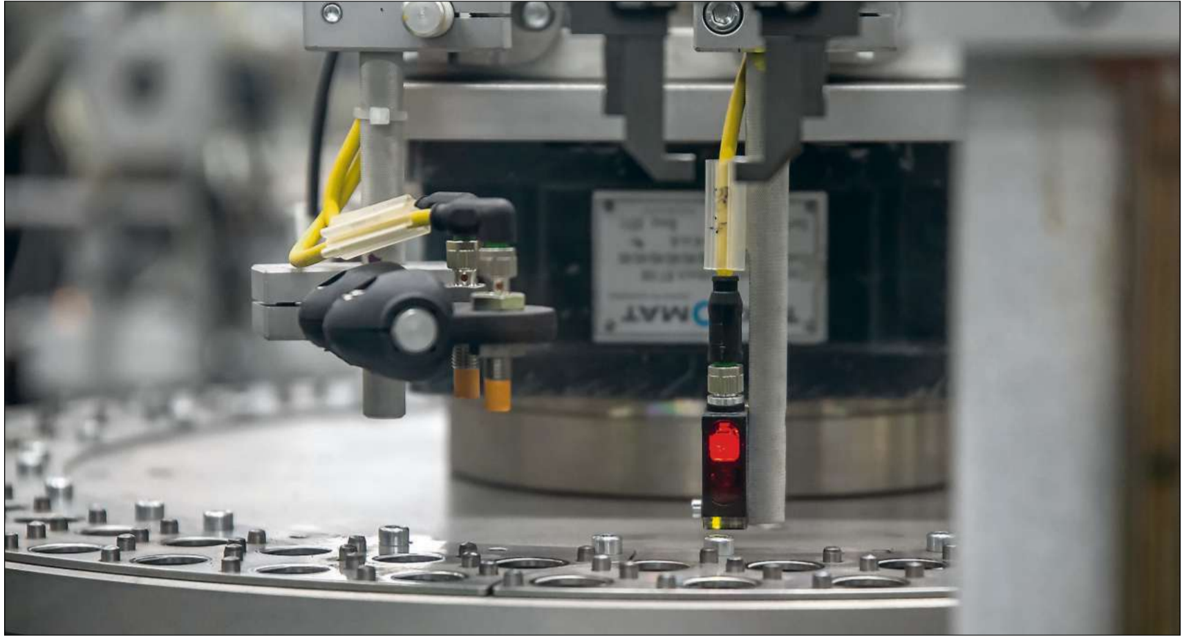
Die bei SGT produzierten Teile werden sofort auch kontrolliert. Die Ausschussquote soll nahe Null liegen.
